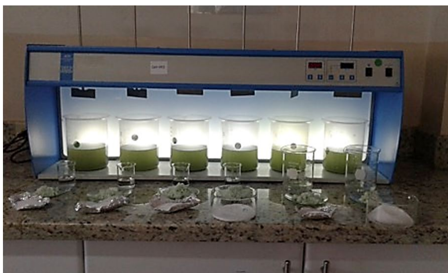
Figura 2. Fotografía de una prueba de jarras realizada con distintas concentraciones de los reactivos de Fenton modificado: \text{H}_2\text{O}_2 , \text{FeSO}_4 y \text{C}_6\text{H}_8\text{O}_7 ; realizado al agua residual de la muestra.
