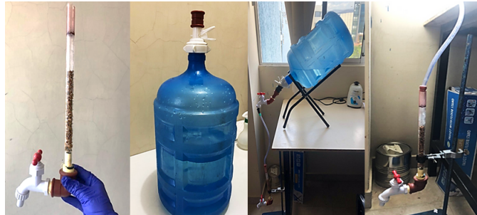
Figura 1. Las diatomeas se colocaron en un soporte de vidrio el cual, a su vez, se conectaba a un grifo en un extremo, y a un bidón al otro.
